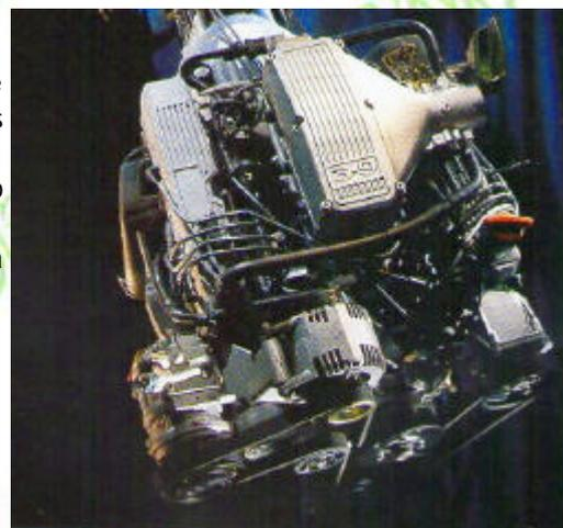
Ambos bancos de cilindros incorporan camisas de acero insertadas hasta el tope del bloque mediante el proceso de contracción térmica. El cigüeñal de cinco apoyos está centrado por un cojinete axial integrado en el cojinete superior de bancada central. El árbol de levas, ubicado en el centro, es comandado por una cadena en forma directa. Las válvulas son operadas por balancines, varillas y botadores (taqués) hidráulicos.
